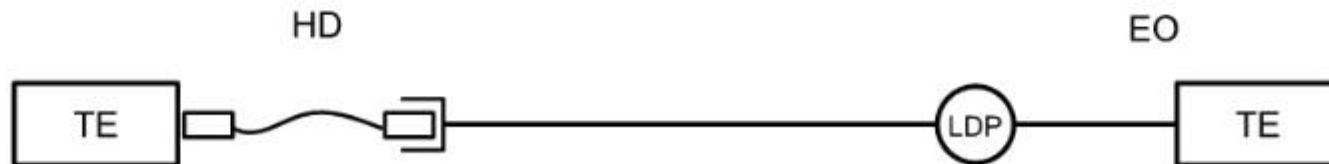
c) Posições dos equipamentos de teste (TE) no canal horizontal, incluindo apenas o LDP
