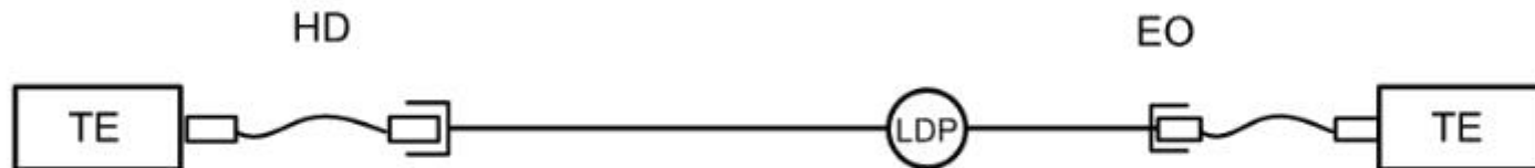
b) Posições dos equipamentos de teste (TE) no canal horizontal, incluindo o LDP
